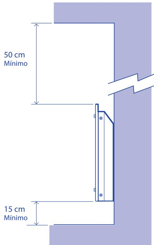
Para el montaje en la pared, el artefacto debe instalarse a una distancia superior a 15 cm del suelo y a no menos de 50 cm del techo.
