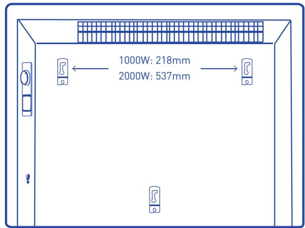
**Nota:** Antes de perforar, asegúrese de que no pasen cables ni cañerías por la pared, a fin de evitar dañarlos. Recuerde que los tornillos de la pared deben estar ajustados y firmes, a fin de garantizar la instalación segura del calefactor eléctrico.
