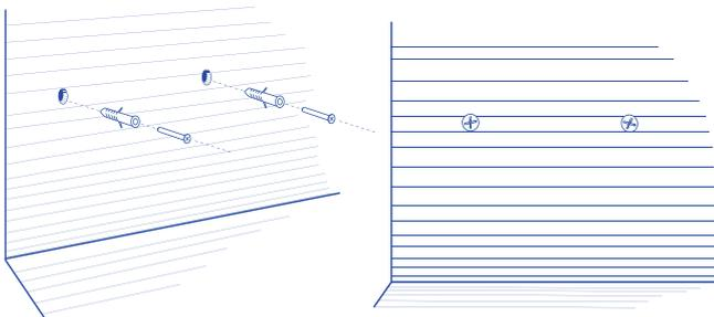
2. Alinee los orificios de los soportes de montaje superiores de la parte posterior del producto con los tornillos de la pared, y enganche el dispositivo en los tornillos. Mueva el artefacto hacia arriba y, luego, hacia la izquierda para que los tornillos encajen en la ranura. Consulte la siguiente imagen.
