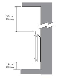
Nota: Antes de perforar, asegúrese de que no pasen cables ni cañerías por la pared, a fin de evitar dañarlos.
