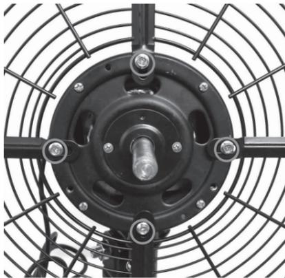
d. Retire la vaina protectora del eje. Tome el aspa y colóquela en la posición indicada. Note que el eje del motor tiene una muesca que debe coincidir con la posición del tornillo del aspa.
