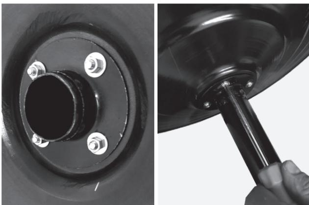
7. Coloque el motor con su acople sobre el barra. Procure hacer coincidir el orificio del barral alineado con la posición donde se encuentra el tornillo de fijación en el acople del motor. Luego atornille el tornillo para fijar el motor al barral.
