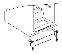
5. Vuelva a colocar la tapa ajustando el cuerpo de la bisagra superior en el orificio superior de la puerta y fíjelo con 2 tornillos. Vuelva a colocar los cubre tornillos.
