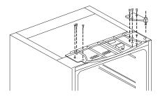
4. Retire ambas patas ajustables y extraiga el soporte de la bisagra inferior aflojando los tornillos.
